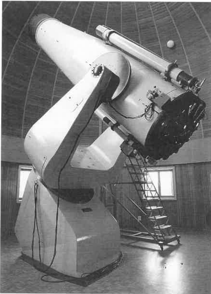
Fig. 2 Telescopio Schmidt di 67 cm impiegato ad Asiago per la scoperta e la fotometria di supernovae .
